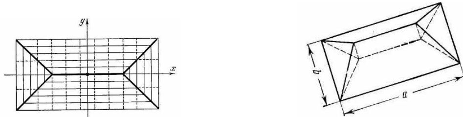
Рис. 3.13: Эквидистантные кривые и поверхность постоянного ската для прямоугольного поперечного сечения.
